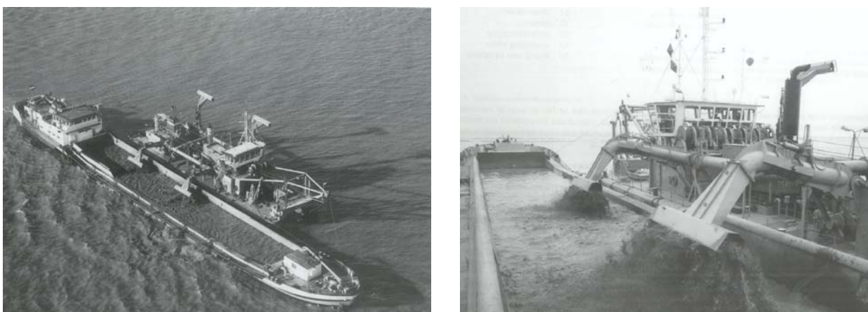
Figuur 5.6 Bakkenladen. Bron: Voortgezette Opleiding Uitvoering Baggerwerken 4 (1998), VBKO
