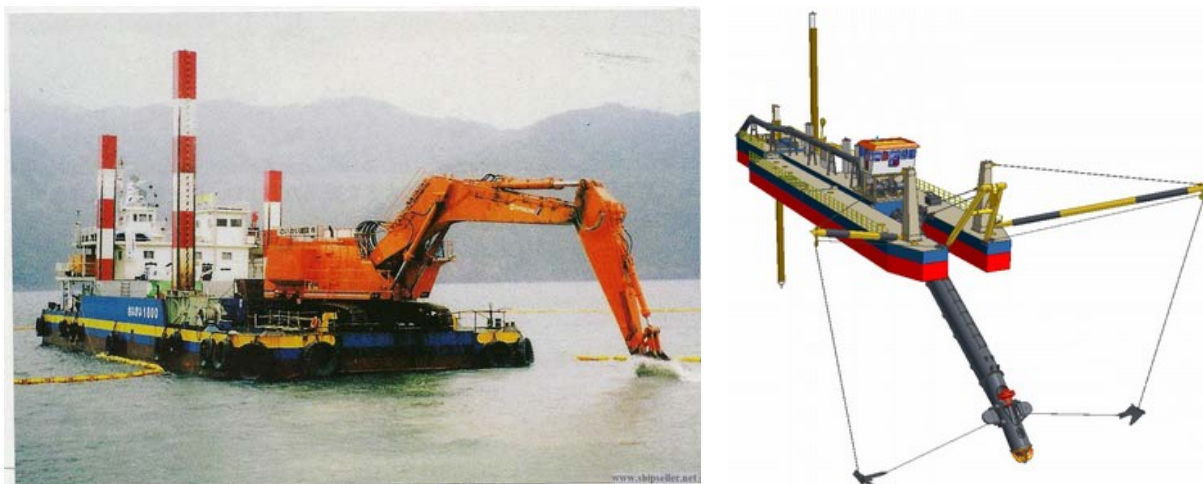
Figuur 5.5 Cutterzuiger of snijkopzuiger
