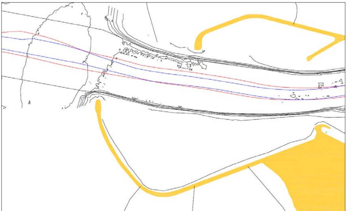
Figuur 6-8 Geveegde baan uitvaarten versmalde havenmond met geballast 340 m schip
