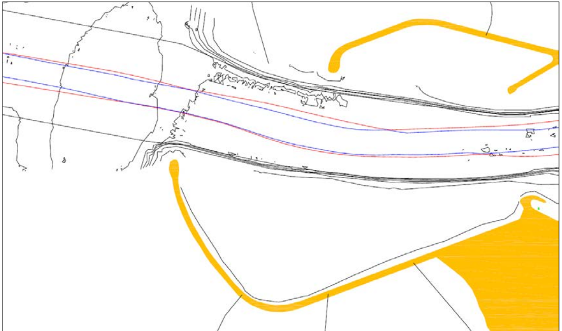
Figuur 6-3 Geveegde baan invaarten bestaande havenmond met geladen 340 m schip
