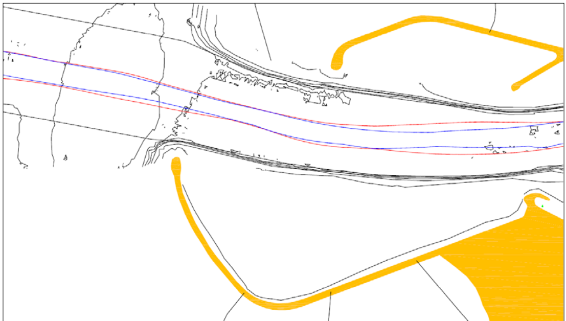
Figuur 6-1 Geveegde baan invaarten bestaande havenmond met geladen 300 m schip
