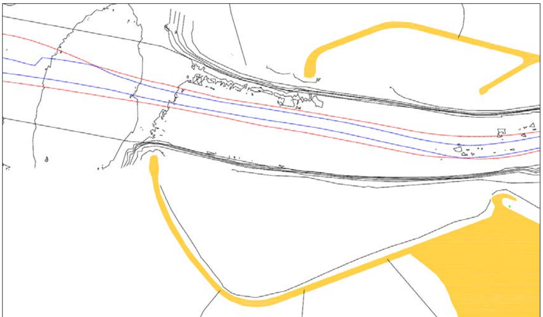
Figuur 6-6 Geveegde baan uitvaarten versmalde havenmond met geballast 300 m schip
