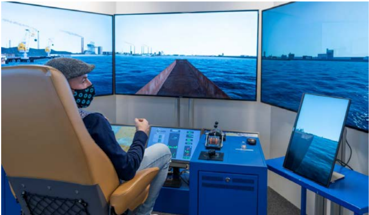
Figuur 3-1: Compact Manoeuvring Simulator (CMS) tijdens de simulaties naar de binnenvaartkade in de haven van IJmuiden
