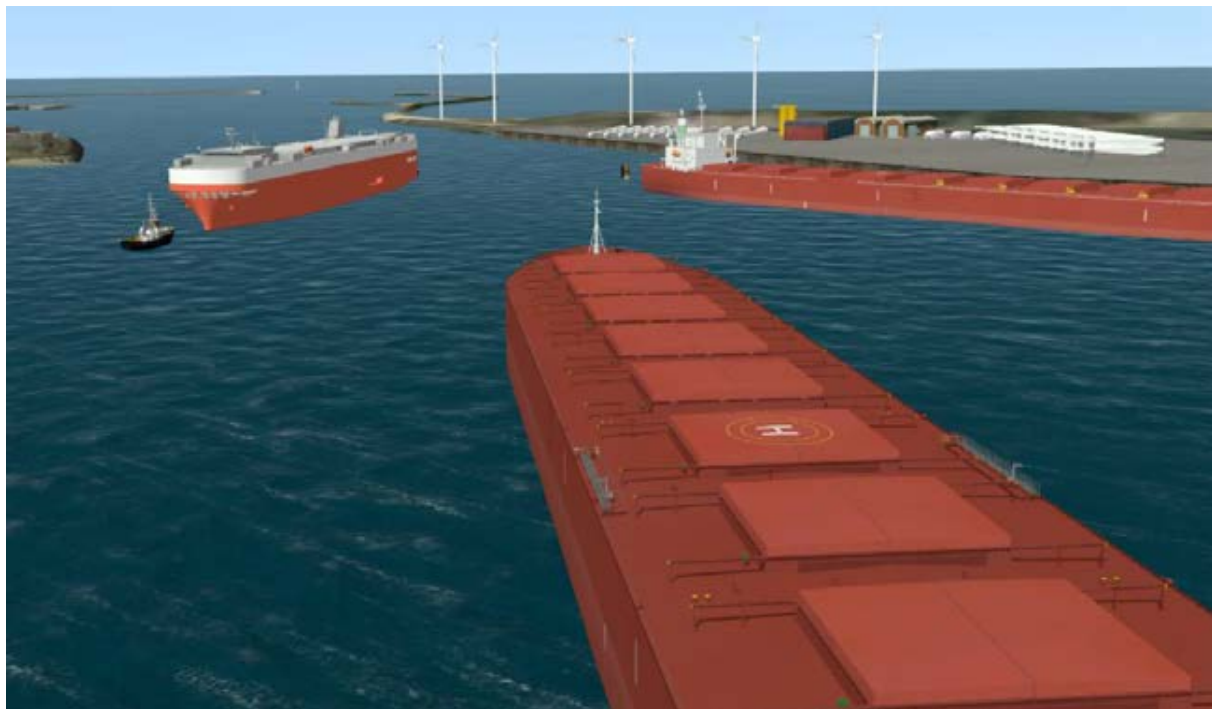
Figuur 2-3: Impressie van het buitenbeeld gedurende de real-time simulaties, met een bezette lichterlocatie en twee ontmoetende schepen.
