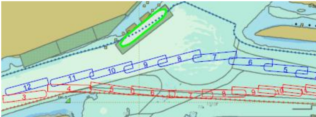
Figuur 4-8: Track-plot van Run 10, ontmoetende auto-carriers bij 15.4 m/s wind uit het zuidwesten.
