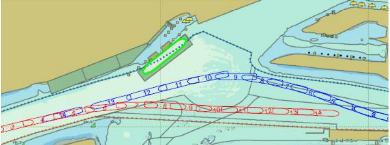
Figuur 4-6: Track-plot van Run 3, ontmoetende Panamax bulkcarriers bij 15.4m/s wind uit het noordwesten.
