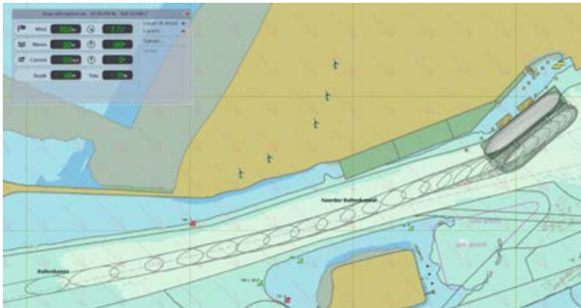
Figuur 4-6: Baanplot van een aankomende Wozmax bulkcarrier naar de lichterlocatie (zie [Ref 3.]).
