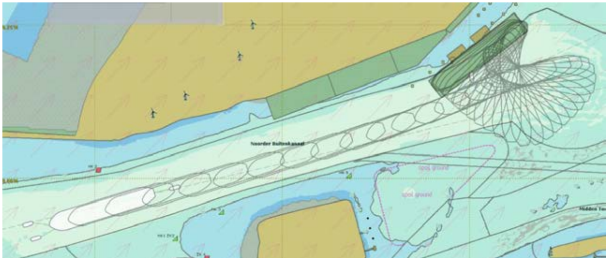
Figuur 5-2: Baanplots van run W5 NW-wind condities (boven) en W6 ZW-wind condities (onder), in 15,4 m/s wind en een spuistroom van 200m 3 /s.
