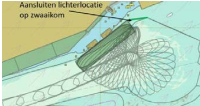
Afbeelding 5.5 Voorgestelde aansluiting tussen baggervak lichterlocatie en bestaande zwaairom
