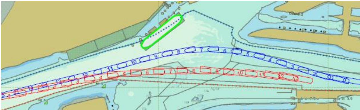
Figuur 5-14: Passage van een inkomende en uitgaande Panamax bulkcarrier op 5 knopen, bij 15.4 m/s wind uit het zuidwesten (gemeerde Wozmax bulkcarrier op de lichterlocatie). Nummers geven de tijd in minuten.
