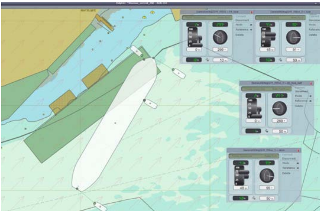
Figuur 5-1 Detail van een vertrek, waarbij de sleepboot op bakboord voor dichtbij de meerpaal manoeuvreert (run W6).
