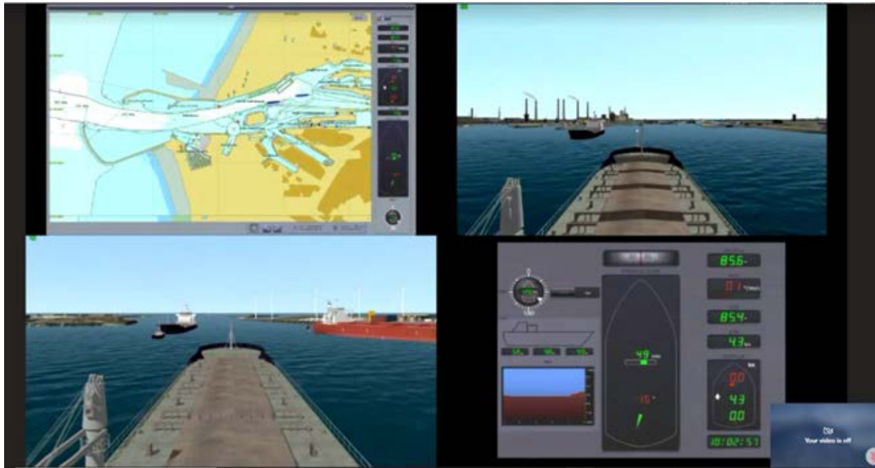
Figuur 3-2: Livestream met linksboven de ENC, rechtsboven zicht vanaf de brug van het inkomende schip, linksonder zicht vanaf de brug van het uitvarend schip en rechtsonder het conning display van het inkomende schip.
