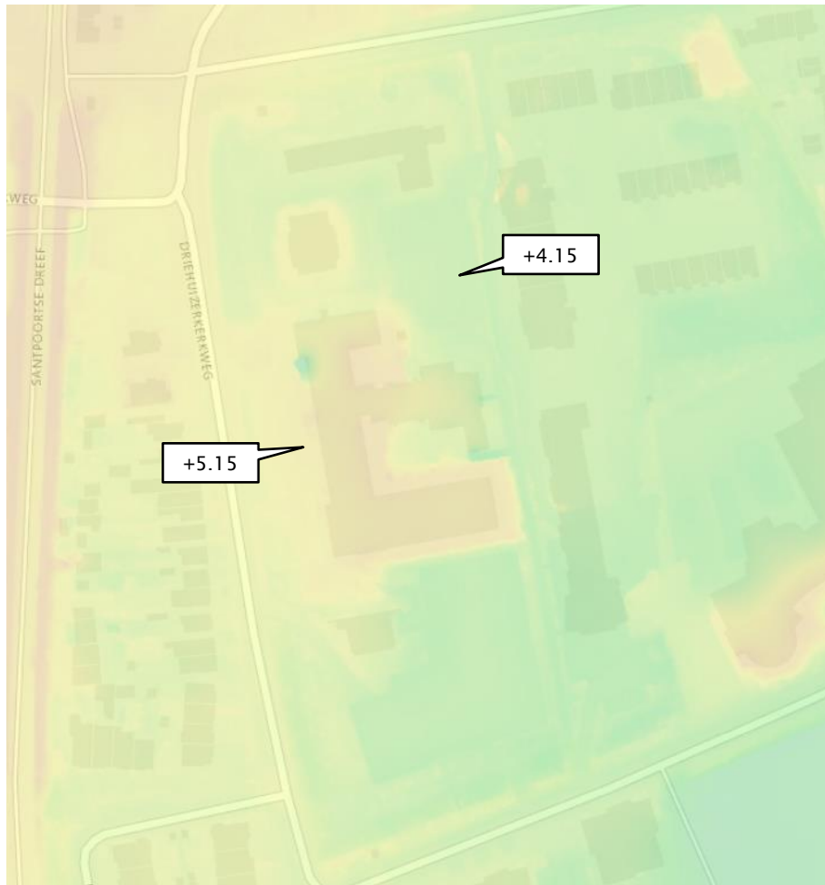
Figuur 2: Bestaande terreinhoogte (bron: AHN3)
