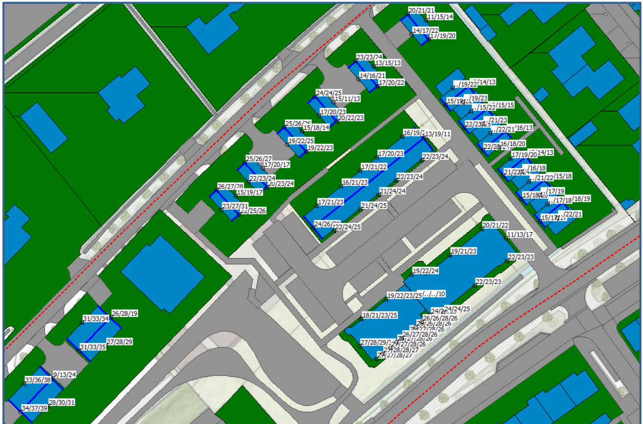
Afbeelding 7. Geluidbelastingen L_{den} (incl. aftrek art. 110g Wgh) Hofgeester Eijnde Berekende geluidbelastingen op een hoogte van 1,5 / 4,5 / 7,5 / 10,5 meter
