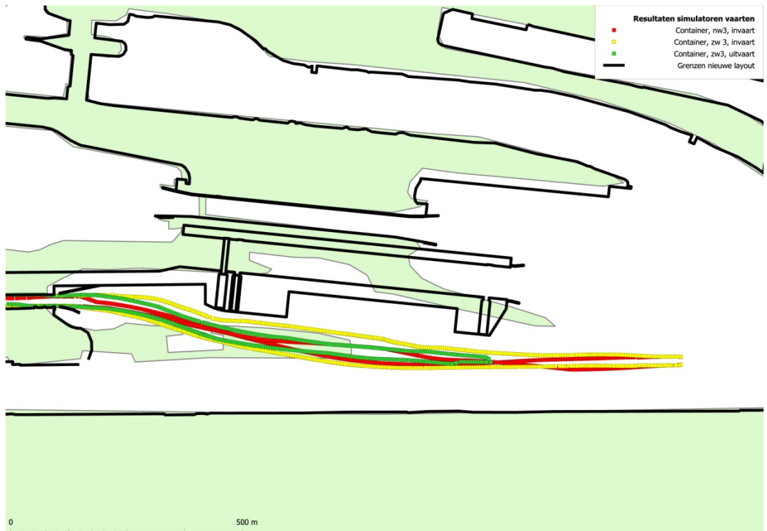
Figuur 5-12 Nieuwe sluis lay-out met daarin enkele resultaten van de simulator vaarten.
