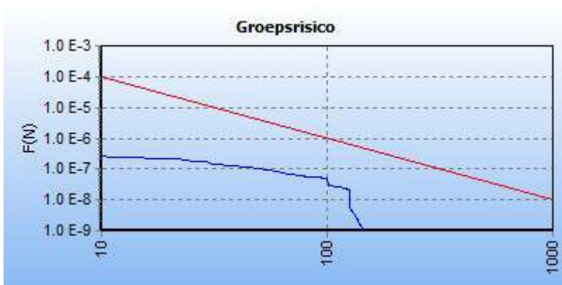
5.6 Figuur 5.6 FN curve voor 7679_leiding-A-561-deel-1 van N.V. Nederlandse Gasunie voor de kilometer tussen stationing 3920.00 en stationing 4920.00
