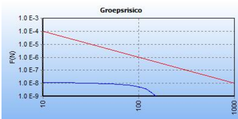
5.5 Figuur 5.5 FN curve voor 5954_leiding-A-554-deel-1 van N.V. Nederlandse Gasunie voor de kilometer tussen stationing 0.00 en stationing 1000.00
