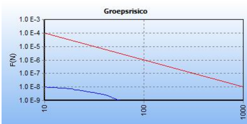
5.5 Figuur 5.5 FN curve voor 5954_leiding-A-554-deel-1 van N.V. Nederlandse Gasunie voor de kilometer tussen stationing 1310.00 en stationing 2310.00
