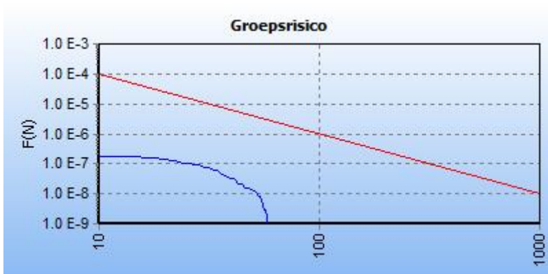
5.11 Figuur 5.11 FN curve voor 5954_leiding-W-534-01-deel-1 van N.V. Nederlandse Gasunie voor de kilometer tussen stationing 0.00 en stationing 1000.00
