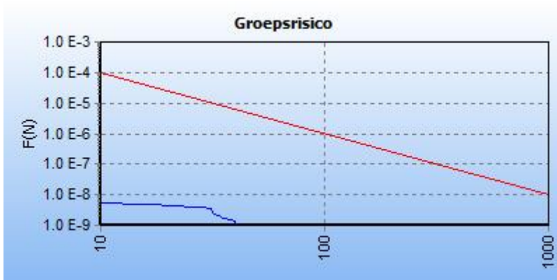
5.11 Figuur 5.11 FN curve voor 5954_leiding-W-534-01-deel-1 van N.V. Nederlandse Gasunie voor de kilometer tussen stationing 0.00 en stationing 1000.00
