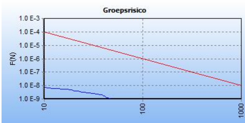
5.5 Figuur 5.5 FN curve voor 5954_leiding-A-554-deel-1 van N.V. Nederlandse Gasunie voor de kilometer tussen stationing 1310.00 en stationing 2310.00
