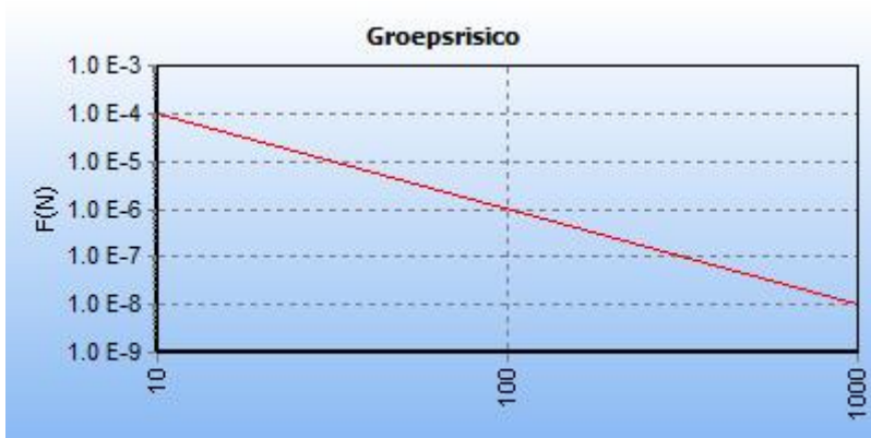
5.17 Figuur 5.17 FN curve voor 5954_leiding-W-534-33-deel-1 van N.V. Nederlandse Gasunie voor de kilometer tussen stationing 0.00 en stationing 20.00
