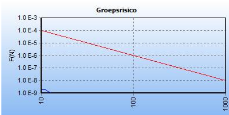
5.14 Figuur 5.14 FN curve voor 5954_leiding-W-534-09-deel-1 van N.V. Nederlandse Gasunie voor de kilometer tussen stationing 0.00 en stationing 1000.00
