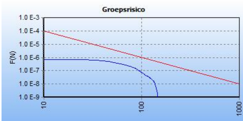
5.10 Figuur 5.10 FN curve voor 5954_leiding-A-803-deel-1 van N.V. Nederlandse Gasunie voor de kilometer tussen stationing 2420.00 en stationing 3420.00
