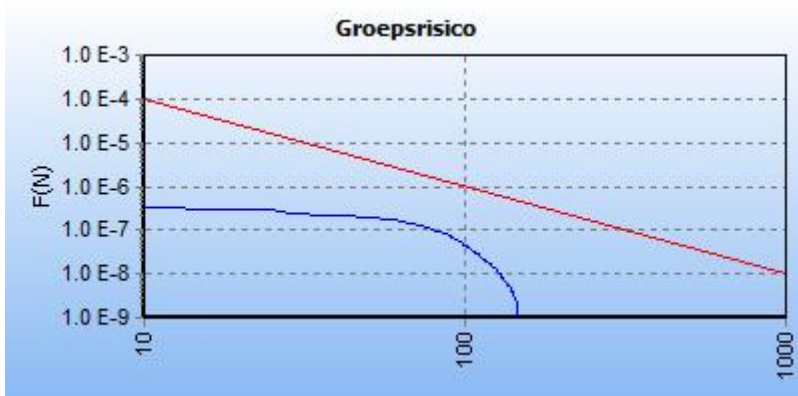
5.10 Figuur 5.10 FN curve voor 5954_leiding-A-803-deel-1 van N.V. Nederlandse Gasunie voor de kilometer tussen stationing 2240.00 en stationing 3240.00
