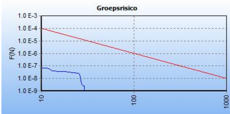
5.4 Figuur 5.4 FN curve voor 5954_leiding-A-553-deel-1 van N.V. Nederlandse Gasunie voor de kilometer tussen stationing 2610.00 en stationing 3610.00
