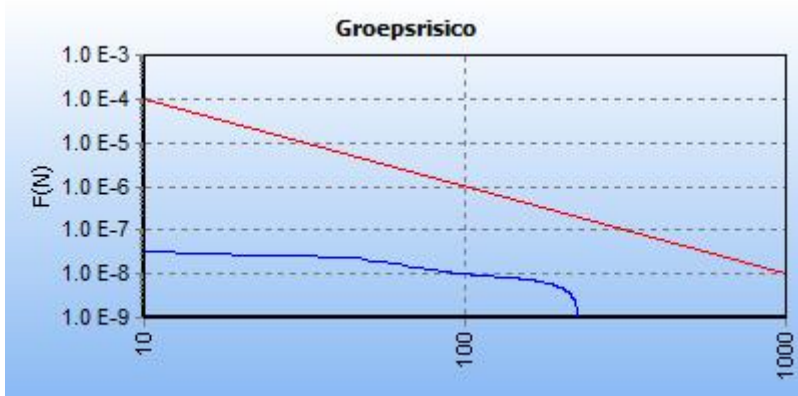
5.7 Figuur 5.7 FN curve voor 5954_leiding-A-561-deel-1 van N.V. Nederlandse Gasunie voor de kilometer tussen stationing 0.00 en stationing 1000.00
