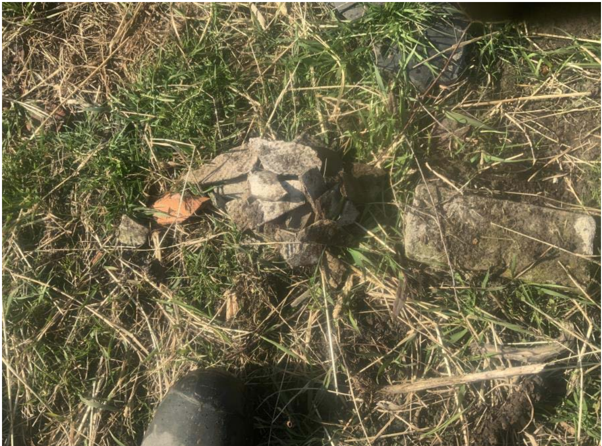
Foto 2: puin en asbestverdacht materiaal op maaiveld
