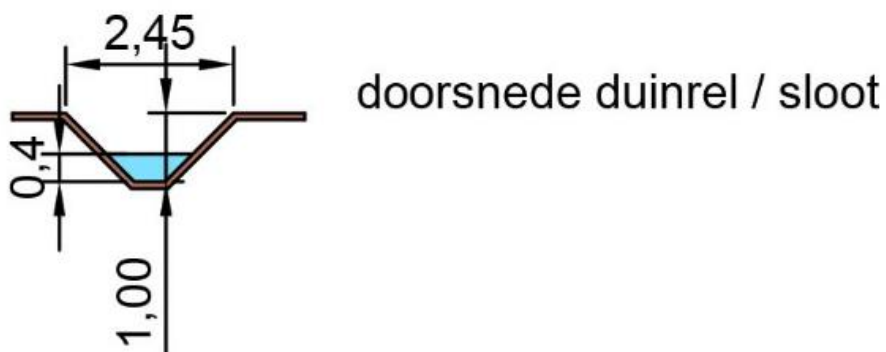
Afbeelding 14 doorsnede duinrel of sloot
