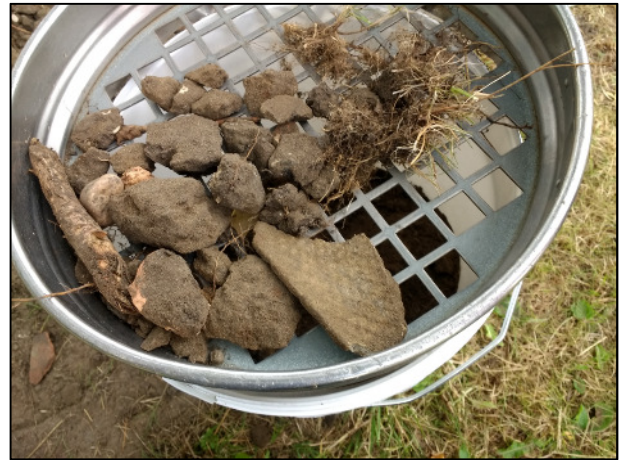
Foto 8: Asbesthoudend plaatmateriaal in proefgat 065
